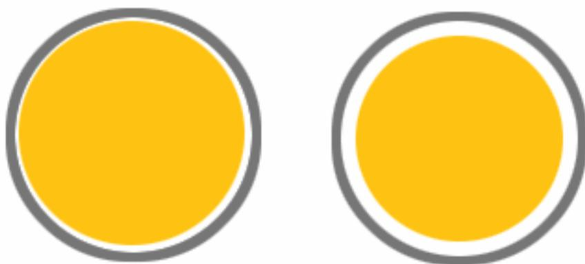
Beispiel: 6,03mm Lauf und eine gute Kugel mit richtigem Durchmesser, rechts: selber Lauf aber ein kleinerer Durchmesser der Kugel - es kommt zu **Druckverlust**.
